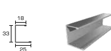
PROFILO/PROFILE "C" 18x33x25 L=4000mm PER STRUTTURA NASCOSTA / FOR HIDDEN STRUCTURE
